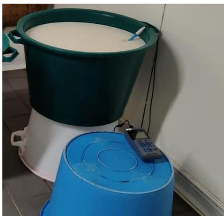
Photo : enregistrement de pH et température dans une bassine de fabrication en ferme lors de la phase de caillage
