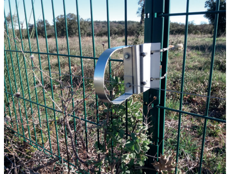
Photo 37 : Exemples de système de sécurité montés sur clôture pour signaler la présence d'une intrusion (© Idele)
