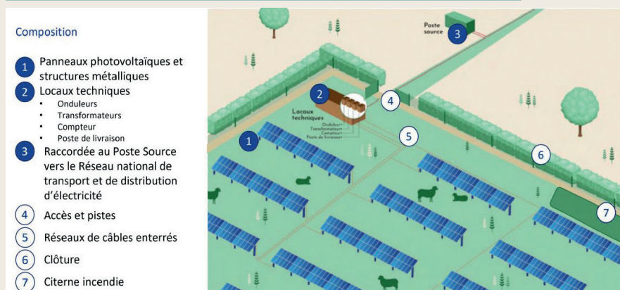
FIGURE 5 : SCHÉMA DE PRINCIPE D'UNE INSTALLATION TYPE AGRIVOLTAÏQUE (SOURCE : QAIR)
