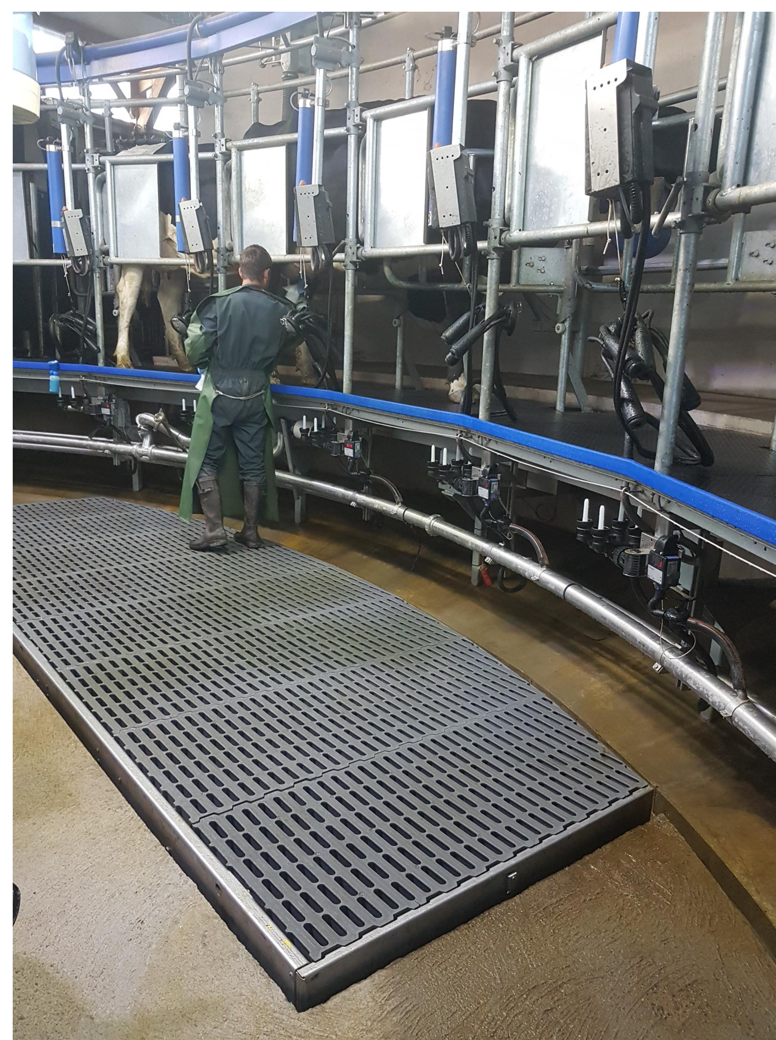
Plancher mobile de fond de fosse (adaptation de la DAV) © DeLaval (ferme expérimentale des Trinottières)
