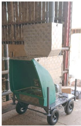
Greenfeed pour mesurer la production de \text{CH}_4 et la corréler aux spectres MIR
