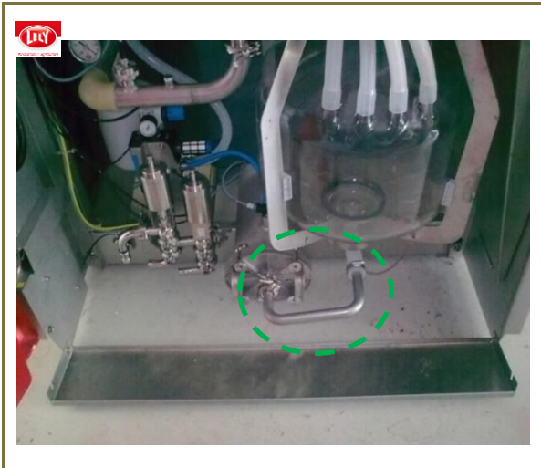
Photo 6.3 : Localisation P3, sur le lactoduc d'évacuation, après la pompe à lait avec une pince « anti-retour » (de lait), pour robots Lely A4
