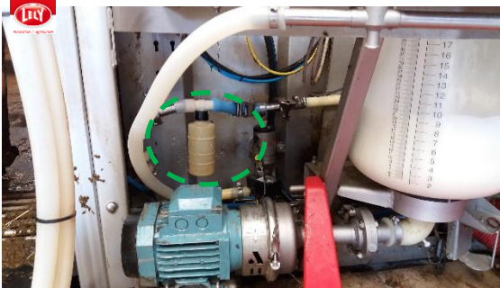
Photo 6.2 : Localisation P3, sur le lactoduc d'évacuation, après la pompe à lait avec une pince « anti-retour » (de lait), pour robots Lely A3 et A3 Next
