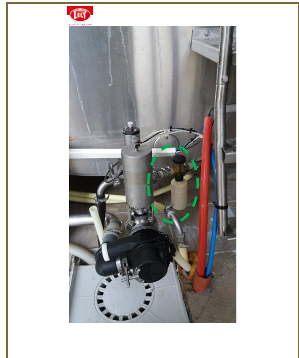
Photo 7.2 : Localisation P4, sur le lactoduc d'évacuation, en amont du tank à lait, pour robots Lely
