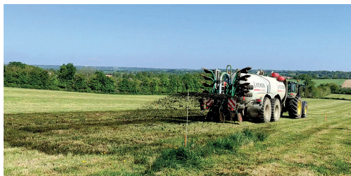
L'épandage avec une buse palette entraîne des pertes d'azote vers l'air.
