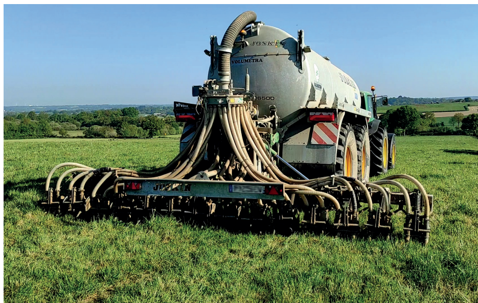
L'injecteur est l'équipement le plus efficace pour limiter les pertes d'azote par volatilisation.
