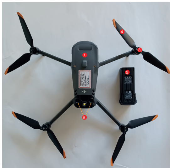
Photos 6, 7 et 8 : description du drone, exemple du DJI MAVIC 3 Enterprise, à gauche vue de dessus, à droite en haut vue \frac{3}{4} haut arrière, à droite en bas vue \frac{3}{4} bas avant.
