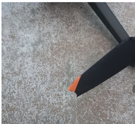
Photo 20 : Hélice de drone endommagée par une collision avec un fil électrique.
