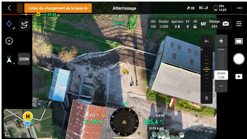
Photo 14 : « Interface « DJI PILOT » permettant une prise en main facile du drone.
