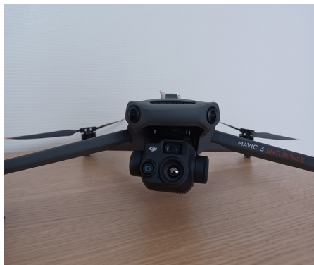
Photo 9 : Drone DJI MAVIC 3 Thermal (vue de face) et ses 3 caméras.
