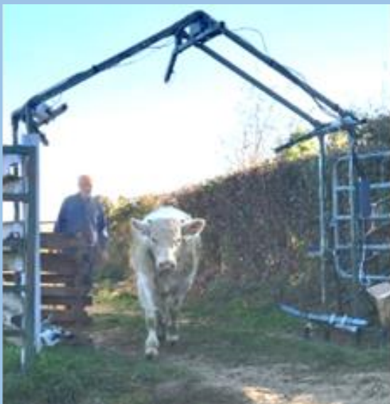
Scanner démontable/ transportable Embarquant 10 RGB-D caméras
