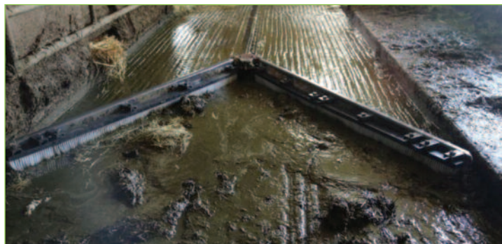
Photo 17 : Brosse fixée sur les volets d'un racleur en V pour améliorer l'efficacité du raclage.
