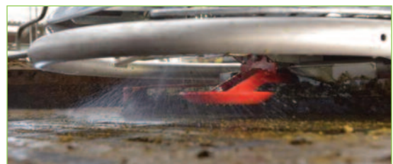
Photo 29 : Robot de raclage avec pulvérisation à l'avant.
