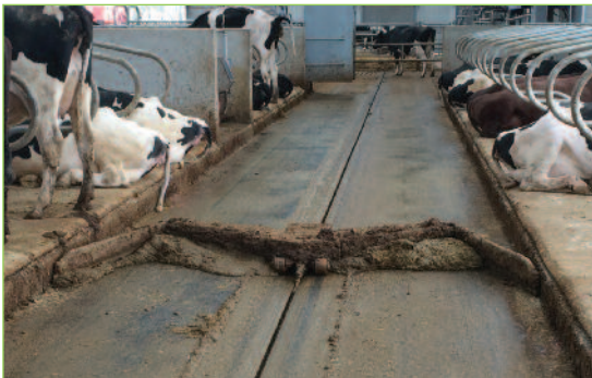
Photo 20 : Racler en W et articulé au centre, adapté aux pentes transversales.
