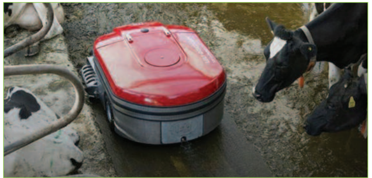
Photo 22 : Robot racler et aspirateur de lisier pour les sols pleins.
