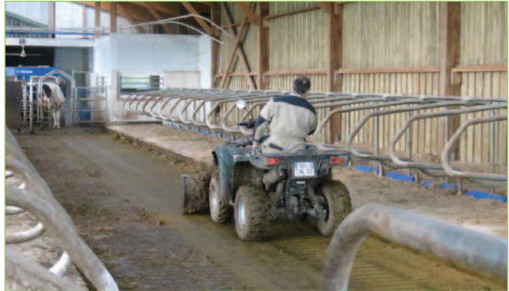
Photo 26 : Raclage des caillebotis avec un quad.
