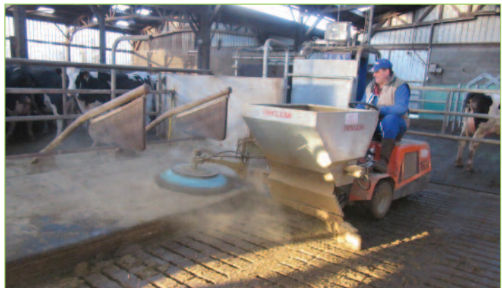
Photo 28 : Raclage des caillebotis couplé à l'entretien des logettes.
