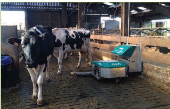
Photo 25 : Robot de raclage pour caillebotis sur sa station de recharge.
