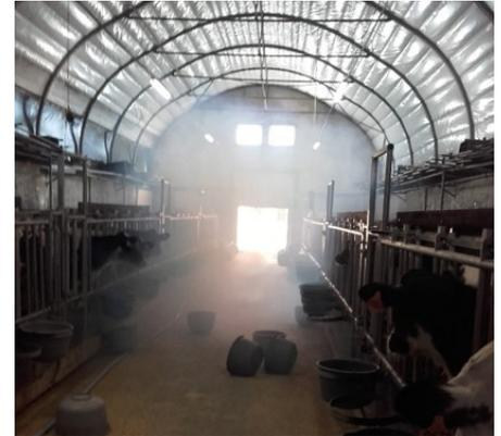
Détection des courants d'air indésirables et vérification de la bonne mise en mélange de l'air entrant avec l'air ambiant à l'aide de fumigènes
