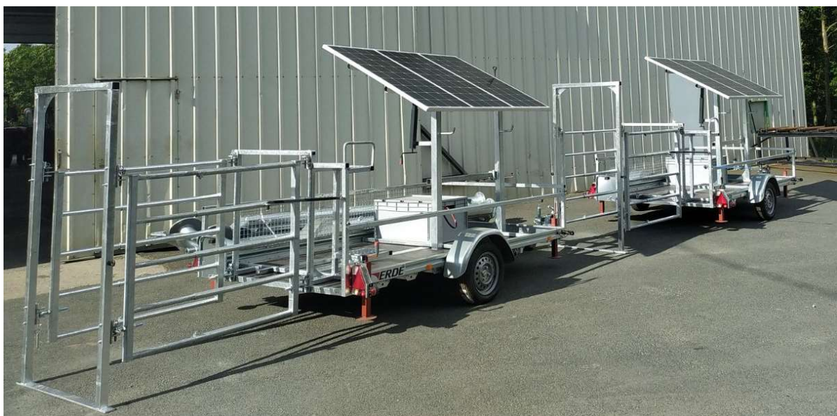
Figure : Photo de deux dispositifs de mobilité pour GreenFeed réalisés à la suite des tests effectués sur la ferme expérimentale des Etablères
