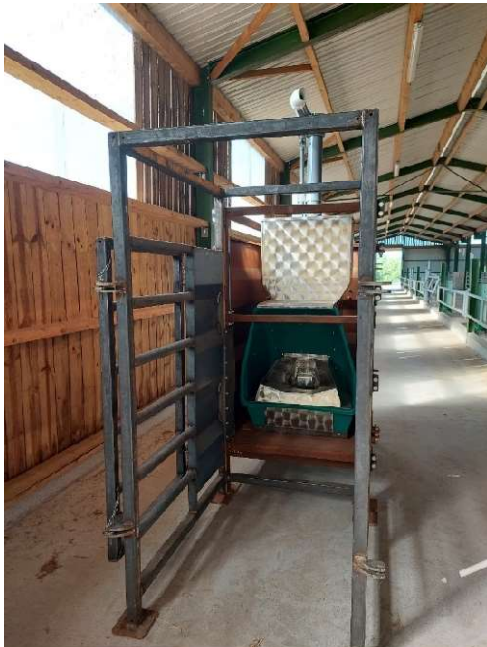
Photos : 2 ème version du dispositif de protection du GreenFeed en bâtiment avant galvanisation
