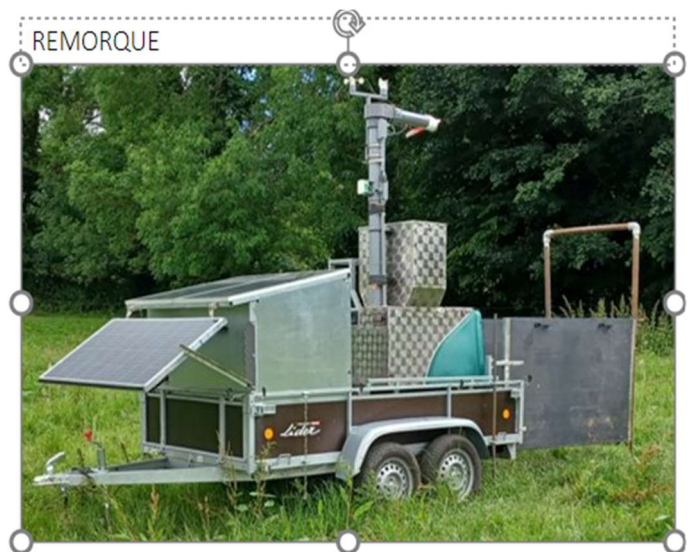
Figure : Prototype de remorque servant à la fois de support au GreenFeed, pour le déplacer de parcelle en parcelle, pour le protéger vis-à-vis des animaux, pour lui assurer une totale autonomie en énergie (panneaux photovoltaïques et batteries de stockage embarqués) et en connexion internet.
