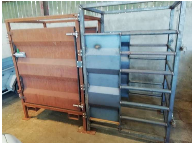
Photos : 2 ème version du dispositif de protection du GreenFeed en bâtiment avant galvanisation
