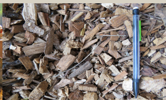
Plaquettes de peuplier en séchage sous hangar pendant 6 mois
