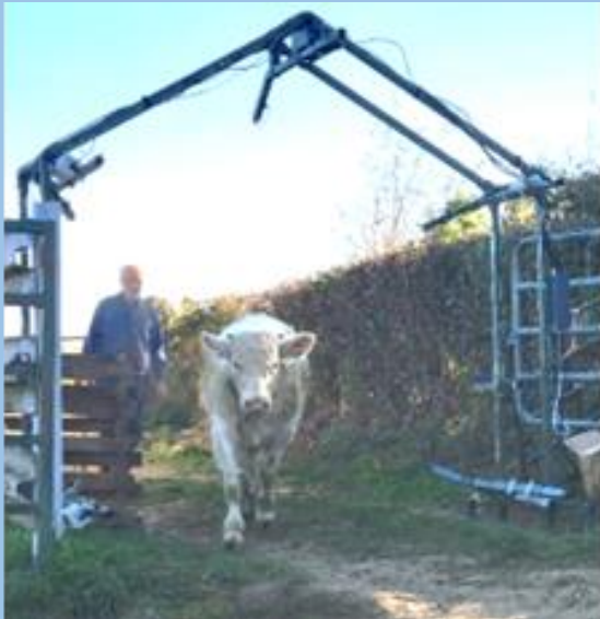
Scanner démontable/ transportable Embarquant 10 RGB-D caméras
