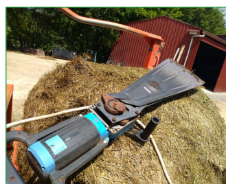
Séparation d'une botte d'enrubannage avec une tronçonneuse à fourrage
