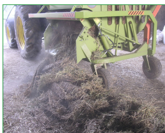
Dérouleuse équipée d'un système de coupe (dérouleuse trancheuse)
