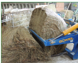
Séparation d'une botte d'enrubannage via une pince coupante
