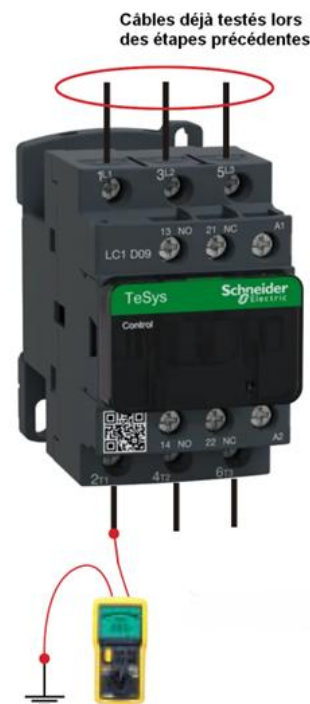
Mesure d'isolement entre chaque conducteur actif et la terre en présence de contacteur
