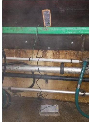
Mise en place de la mesure de tension de contact (Source : CROCIT Bretagne)
