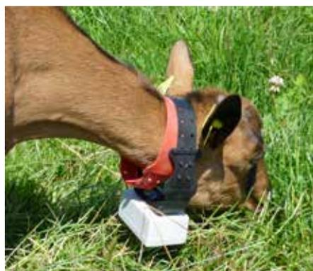
Collier Lifecorder (accéléromètre) permettant de mesurer automatiquement le comportement alimentaire des chèvres au pâturage
