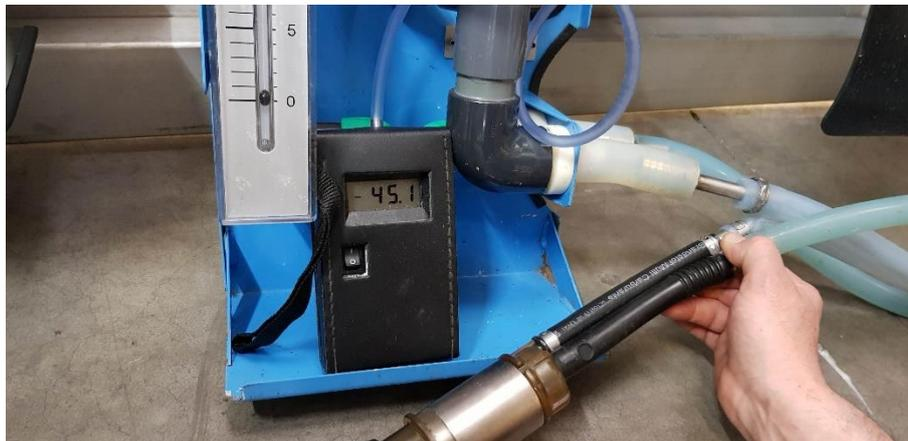
4. Mesurer la fuite du clapet de fermeture de vide (vanne coupe vide décrochage),
