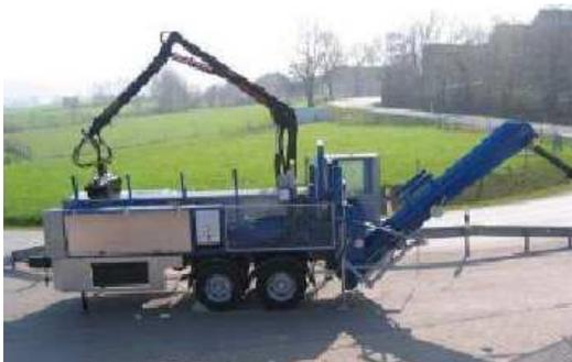
Photo 2 : Combiné scieur fendeur
