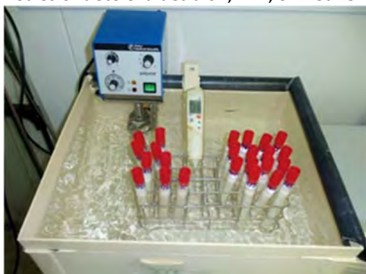
Figure 11 : Incubation de laits dans un bain-marie thermostaté
