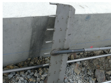
Photo 10 : Rouleau empreinte en losange pour béton frais, utilisée à la SCIA des Coëvrons (53)
