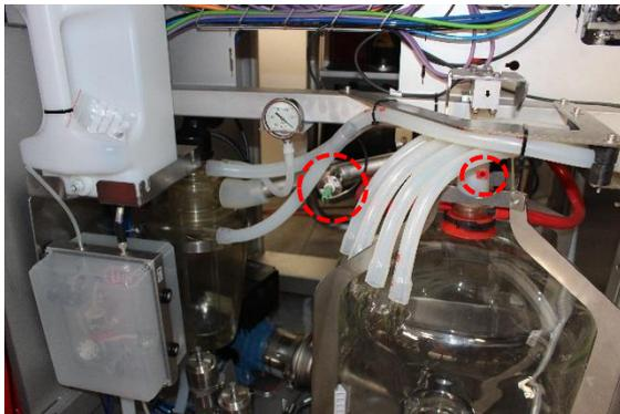
Photo 1.1 : Position du point Vm et du capteur de pression
