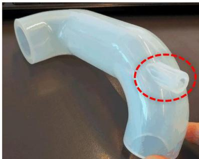
Photo 1.2 : Connexion canalisation à air - chambre de réception, avec point Vm
