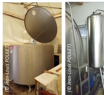
Exemples de « tank ouvert » (à gauche) et de cuve tampon (à droite)
