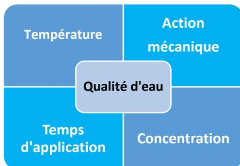
Schématisation des principes de base pour un nettoyage efficace
