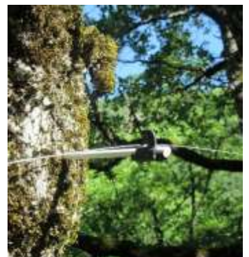
Photo 1: Isolateur d'arbre fait à partir d'un piquet fibre
