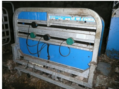
Cellules optiques déplaçables qui déclenchent la fermeture
