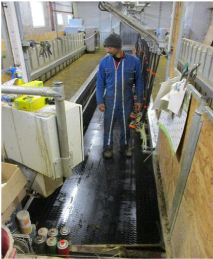
En cas de chute d'une brebis, ce système permet de **remonter le fond de fosse à la hauteur du quai** de traite. Un **tapis souple** sur le fond de fosse **limite les chocs** pour les articulations du trayeur.
