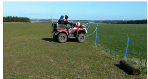
Passage du quad sur les clôtures sans ouvrir les portes
