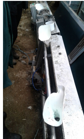
Support artisanal pour poser les pistolets drogueurs
