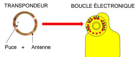
Le transpondeur (couple puce + antenne) est passif, il ne dispose d'aucune alimentation.
