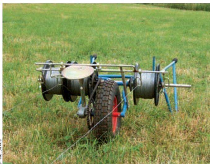
Avec le chariot Rappa, l'enroulement des 3 (ou 4) bobines ainsi que les guides fil sont actionnés par la roue via un système de transmission.
