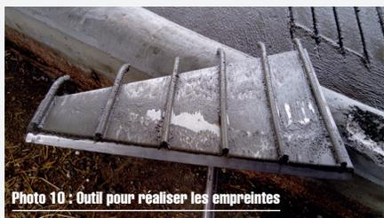
Plaque en inox vue du dessous pour réaliser une empreinte sur béton frais
